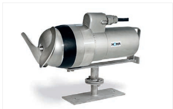
CHRS: Edelstahl-Motorgehäuse und Elastomere aus Viton erlauben auch den Einsatz in chemisch aggressiven Medien.
